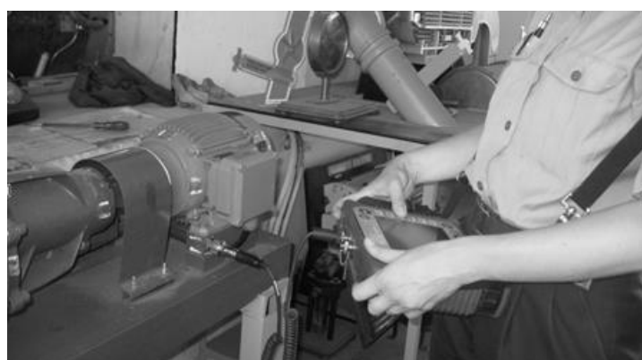
Figura 4.4 Medição de vibração num ponto do protótipo
